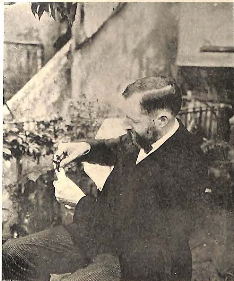
FIG. 2 — PREPARAR O LUGAR DO DETONADOR NO CARTUCHO
