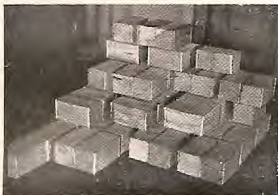
Moda como deve ser feito o carregamento de fructas nos vagões. Observe-se a amarração dos caixas.
