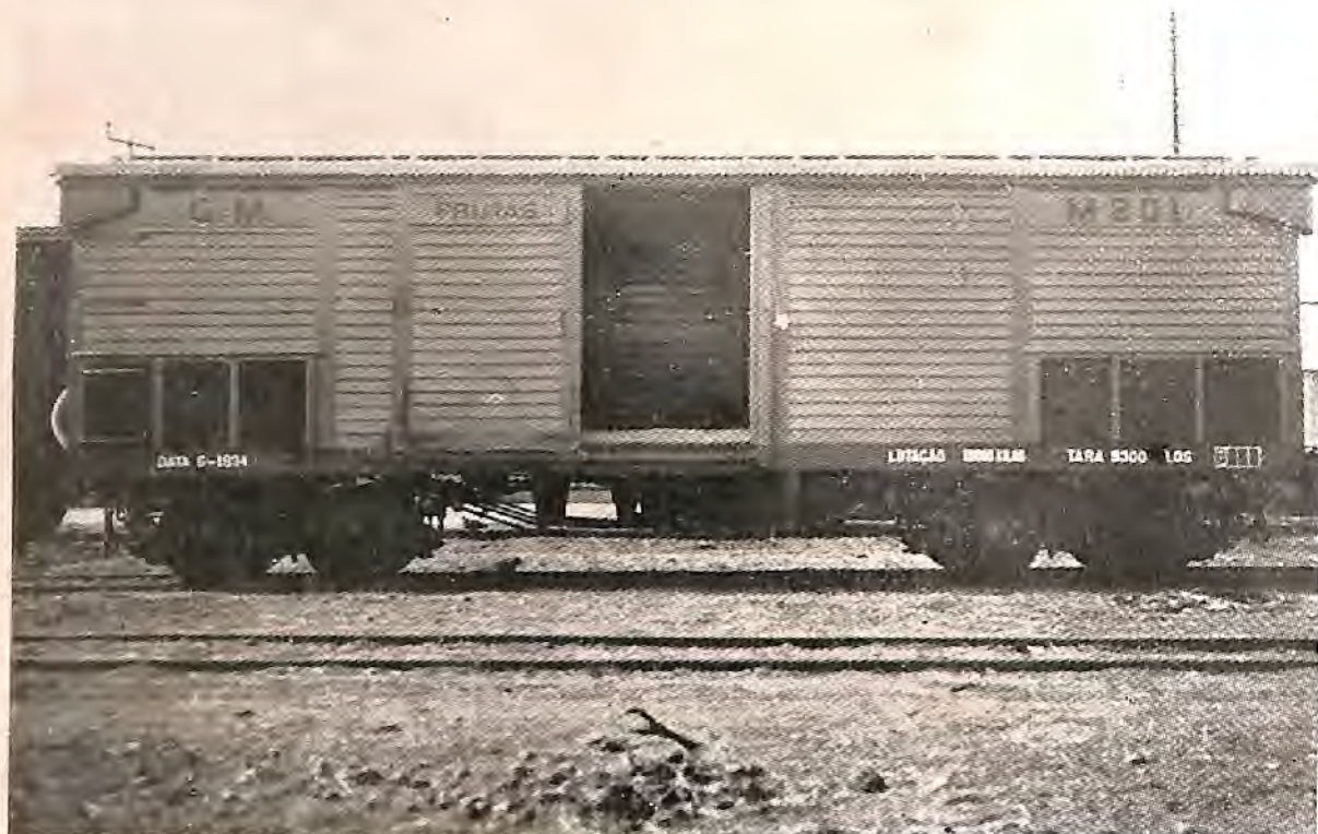
Vagão experimental recentemente construido pela Companhia Mogiana para transporte de fructas.
