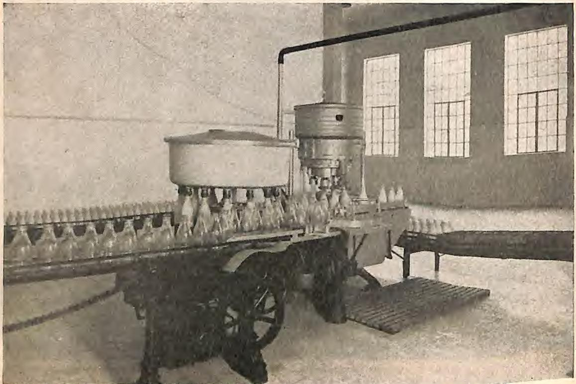
*As manipulações do leite posteriores á ordenha se não forem realizadas dentro dos preceitos técnicos, representarão fonte abundante de contaminação. Em S. Paulo o engarramento do leite, nas Uzinas, é uma operação modelar, conforme se poderá ver na ilustração.*
