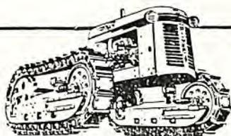
O "OC-3", a gasolina, com 22 H.P. na barra de tração, é construído com bitolas de 31", 42", 60" ou 68", que lhe permite ser utilizado nos mais variados serviços, quer em operações de terraplenagem em encostas, quer penetrando densos canaviais.
