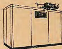
Vista posterior, com quadro de comando e unidade condensadora (compressor, motor, condensador, etc.). Essas unidades condensadoras serão orçadas à parte.
