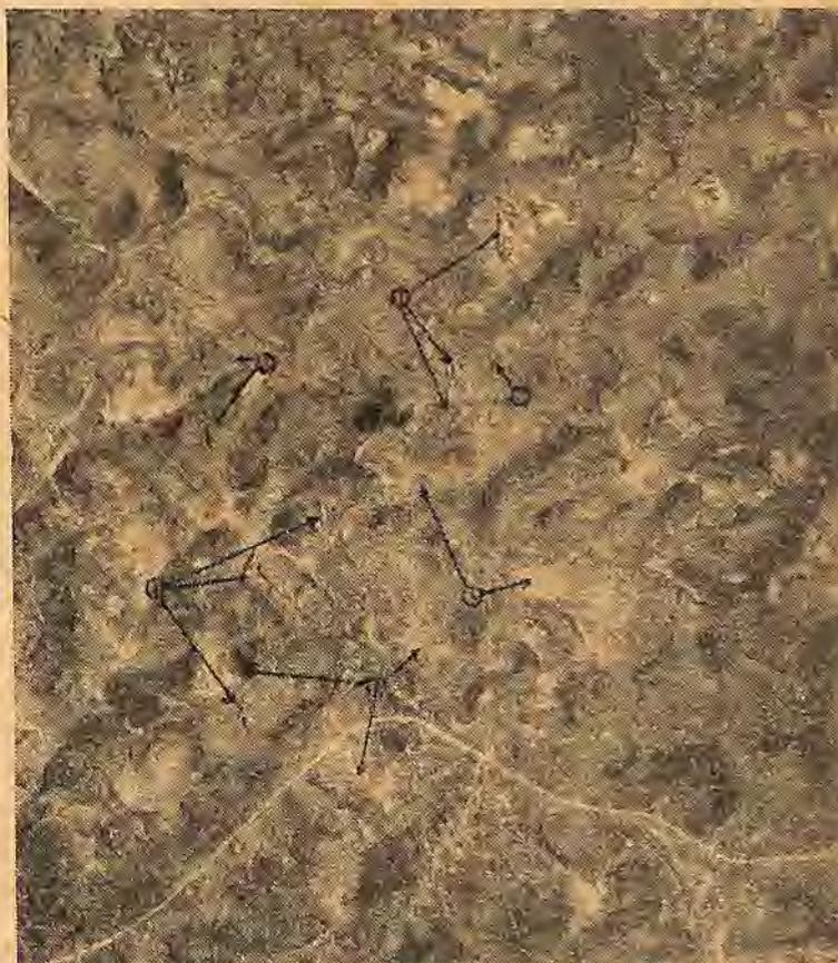
Foto n.º 6 — Fotografia aérea abrangendo 4.900 hectares de terras intensamente erodidas onde se distingue: — 1 — Vassorocas em pleno desenvolvimento; 2 — Vassorocas estabilizadas temporariamente; 3 — Áreas com afloramento do horizonte "B" devido a erosão em lençol.
