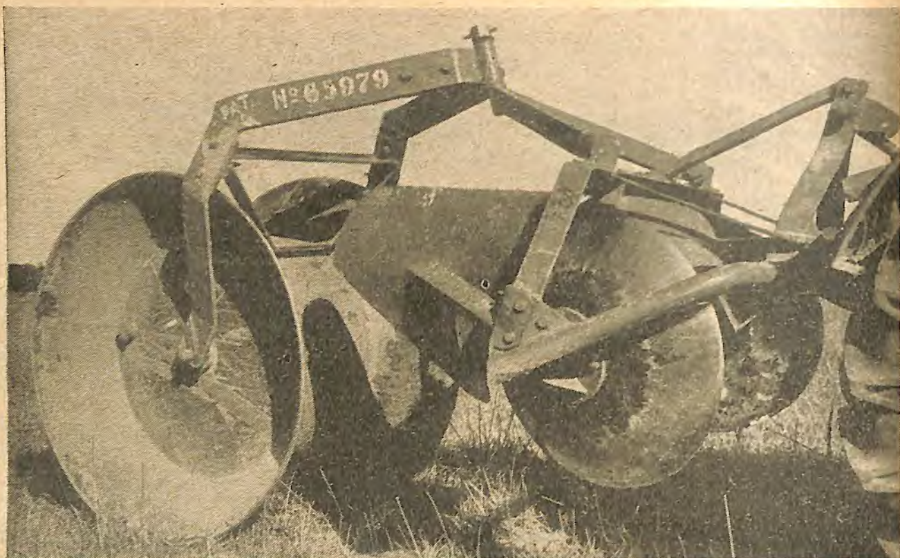
A entaipadeira para levante hidráulico (3 pontos) . Está no campo mostrando os discos e o rôlo. Veja-se a aiveca na parte superior do disco.
