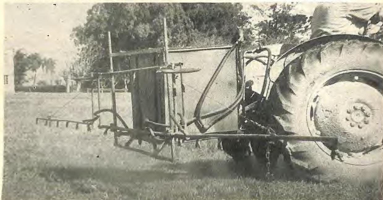
Pulverizador Schwertner modelo RSP-8, com capacidade de 380 litros (água e produto) e com uma pressão de 2,8 a 3,0 atmosferas, adaptado a um trator Massey-Ferguson TO 30, utilizado em nossa pesquisa para aplicação do herbicida. Em cada área de 2 hectares empregamos STAM F-34 na dose de 4,0 l/ha do produto ativo e ENDREX 20, na dose de 1,2 l/ha do produto comercial, misturados simultaneamente.
