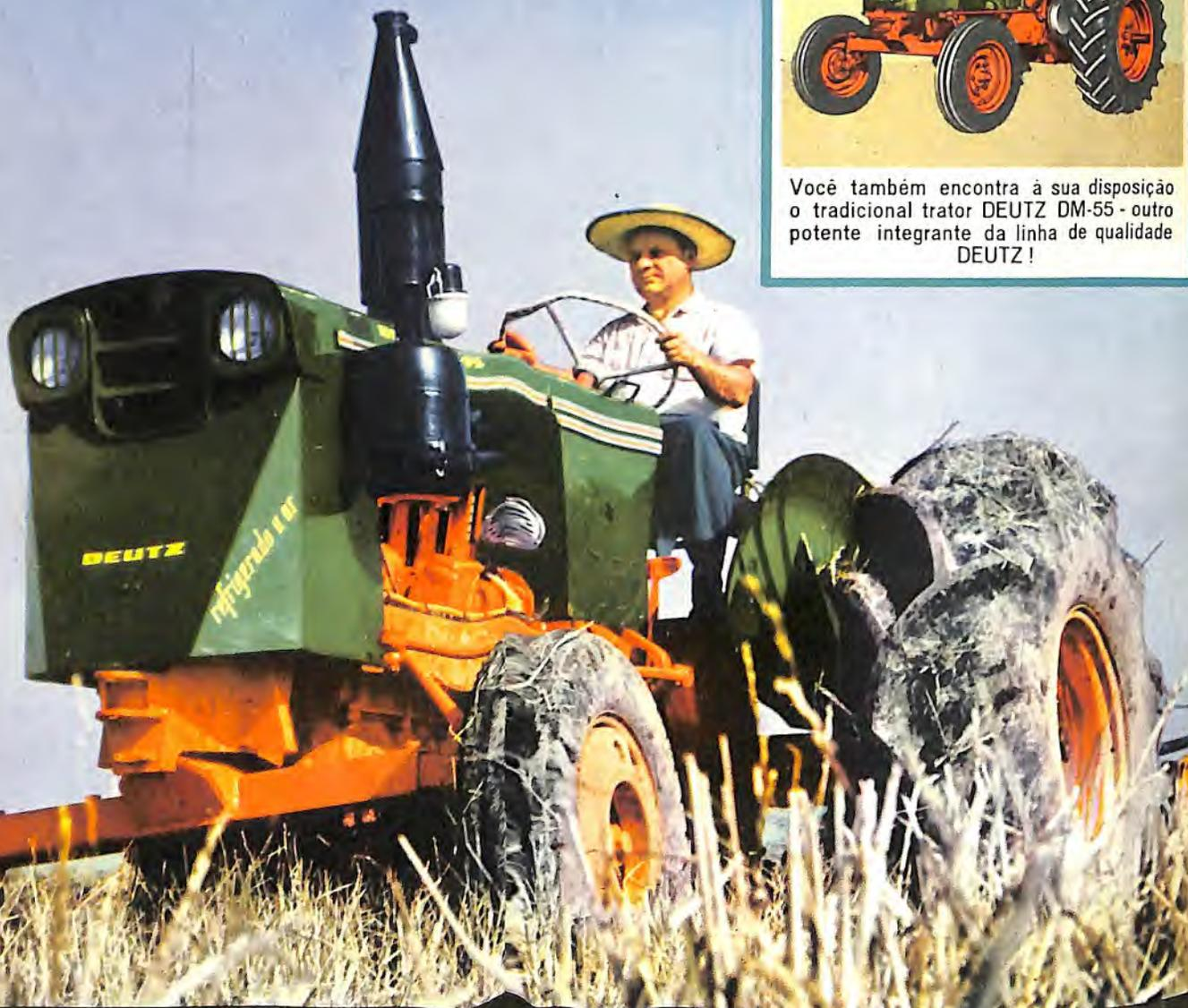
75 HP de potência e economia. Novo DEUTZ DM-75, o trator que incorpora os mais avançados aperfeiçoamentos técnicos. Motor resfriado a ar, controles simplificados, maior capacidade de tração e assento perfeitamente anatômico. Adquirir um novo DEUTZ 75 HP e tenha à sua disposição a Assistência Técnica Automática Absoluta: Carros-Oficina a serviço de tudo o que necessitar de seu trator!
