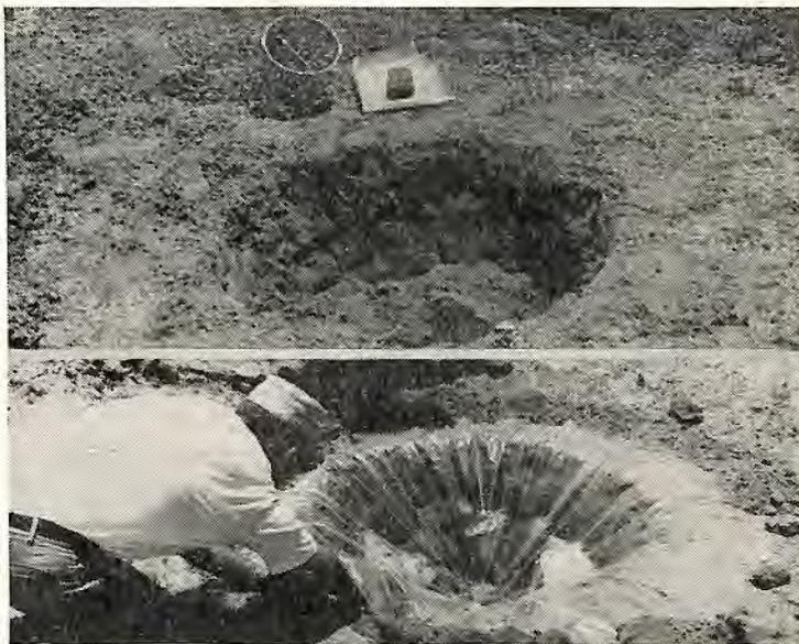
Na foto dois detalhes da preparação do "destilador solar". Em cima, a cavidade já pronta, vendo-se também o recipiente, a folha de plástico ainda dobrada e a pedra. Em baixo o destilador já montado, vendo-se a pedra colocada no centro da folha a fim de dar-lhe a forma cônica necessária
