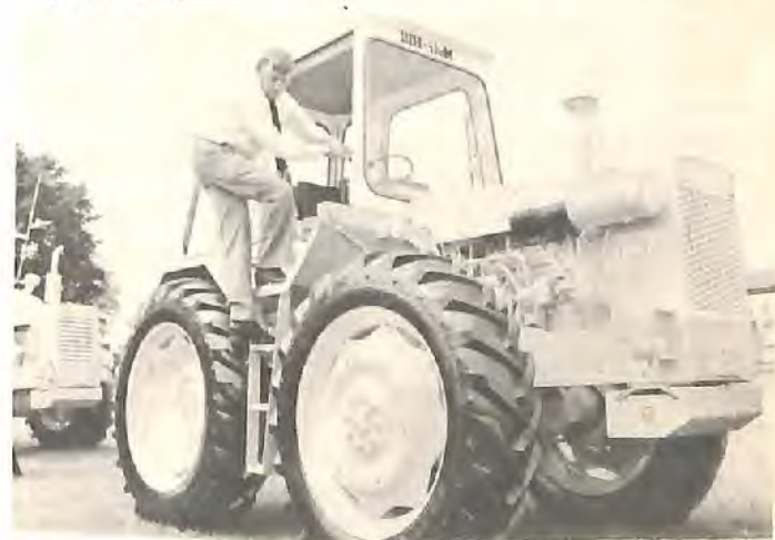
O trator agrícola para serviço pesado Muir-Hill 111, modelo compacto de rendimento máximo com tração nas quatro rodas, apresentado pela companhia britânica Muir-Hill.
