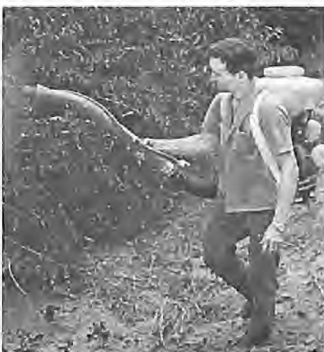
Os equipamentos recomendados para pulverizações a baixo volume são os atomizadores costais motorizados.
