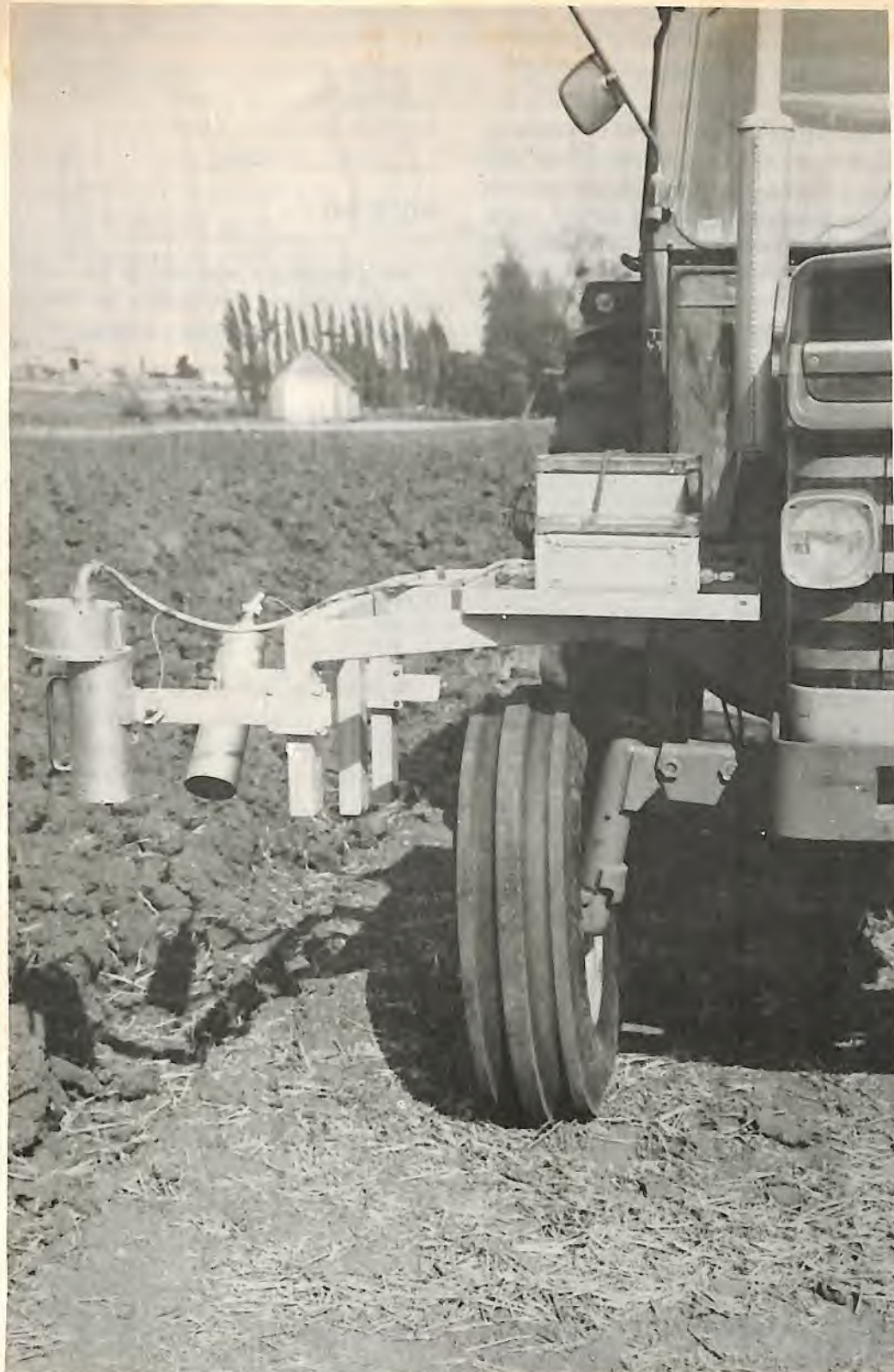
Uma demonstração do sistema que utiliza o sulco do arado como guia e uma técnica ótica para detectar a posição do sulco, pesquisado pelo Instituto Nacional de Engenharia Agrícola da Grã-Bretanha.
