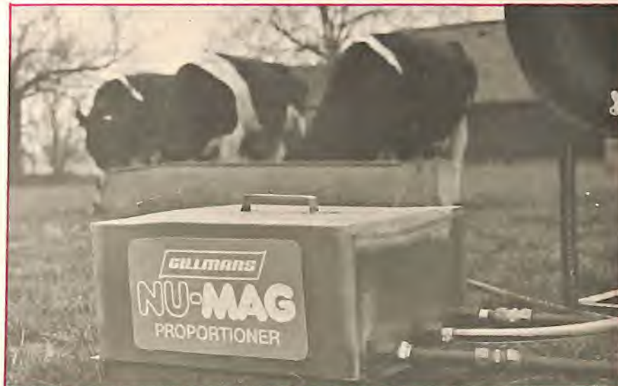
A bomba de "dosagem", que faz parte do sistema "Nu-mag", lançado recentemente por uma companhia britânica. Este sistema previne uma doença do gado, causada pela carência de magnésio, ministrando doses certas à água que o animal bebe.
