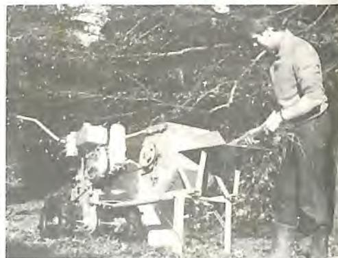
Esta compacta máquina de debulhar é um dos vários equipamentos auxiliares de uma versátil cultivadora motorizada que, segundo os fabricantes, permite ao pequeno proprietário mecanizar completamente suas operações agrícolas a uma fração do custo normal (Foto BNS).
