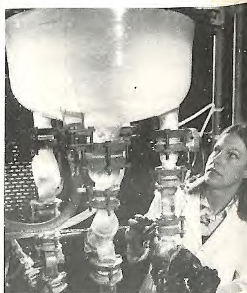
Os microorganismos cultivados neste vaso de fermentação, em uma universidade do sul da Inglaterra, podem ser a chave para reduzir a subnutrição mundial de 1990 em diante. Uma equipe do Conselho de Pesquisas Agrícolas trabalha para substituir os atuais métodos de produção de fertilizantes de nitrogênio – grandes consumidores de energia e vitais para o rendimento de grandes lavouras – por um processo mais eficiente e barato (Foto BNS).
