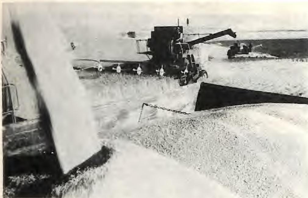
Modernas ceifadeiras-empilhadeiras, que podem executar todas as fases da colheita numa única operação, cobrem comumente milhares de hectares em poucas horas. As unidades de autopropulsão dispõem de uma capacidade superior a duas toneladas métricas e podem ser rapidamente descarregadas. Antigamente as máquinas eram operadas apenas por ceifeiros contratados ou produtores de cereais por atacado, mas hoje o equipamento de colheita mecanizada prevalece até mesmo nas fazendas de pequeno porte.
