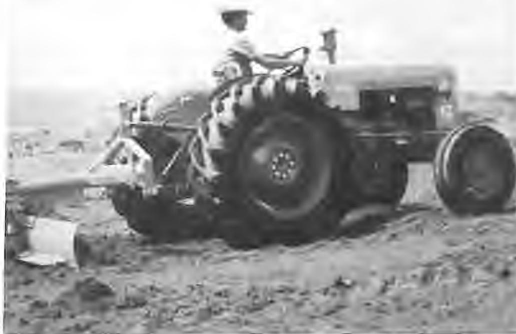
um jeep: um é construído para velocidade e pequena força tratora, o outro pode dar a mesma velocidade mas tem maior força tratora e aderência.
