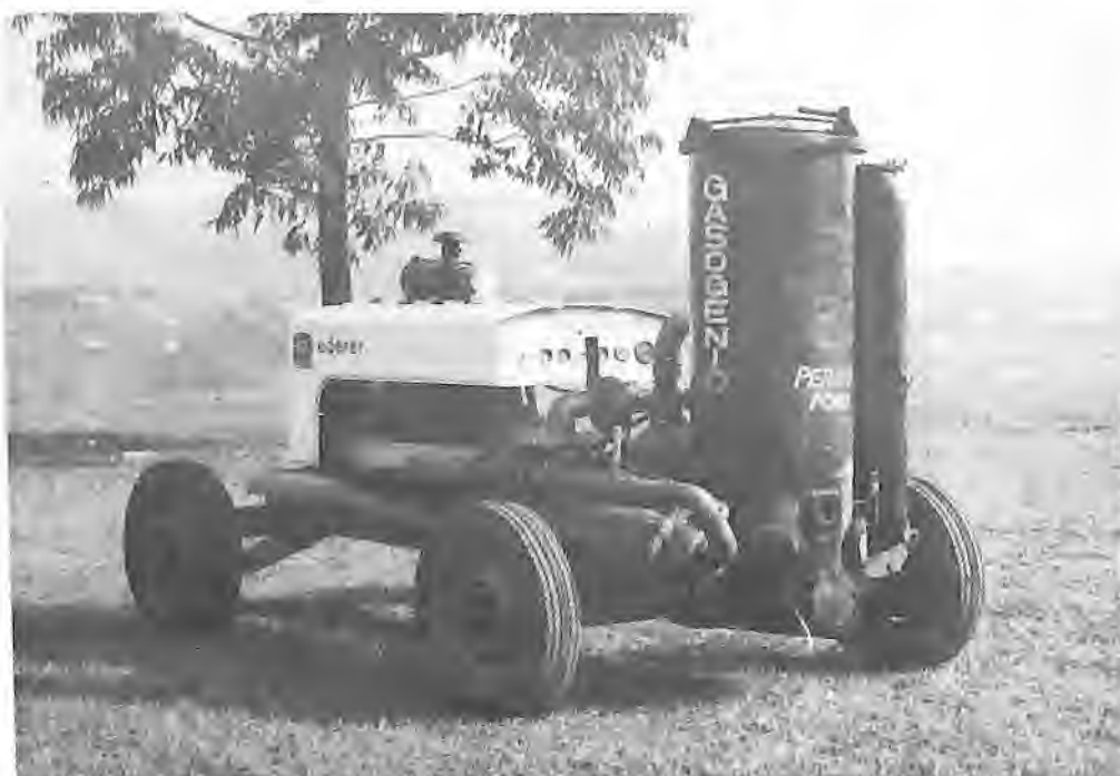
Moto-Bomba à Gasogênio, mais uma alternativa na produção de energia.
