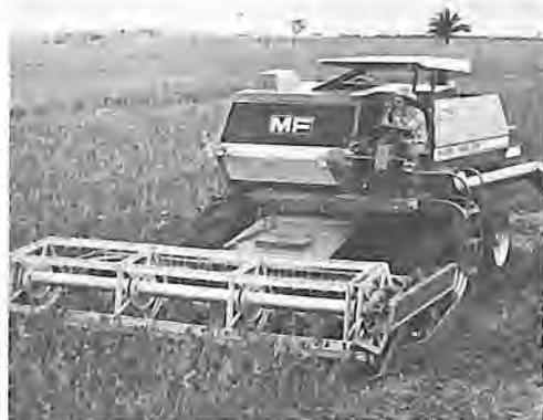
A Massey-Ferguson colocou no mercado a colheitadeira automotriz MF 5650. Equipada com motor diesel Perkins A-6.354,4 de 117 CV de potência, apresenta ótimo rendimento nas mais diversas condições de trabalho.
