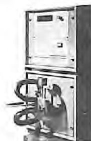
Refractomat: refratômetro automático da Micronal.
