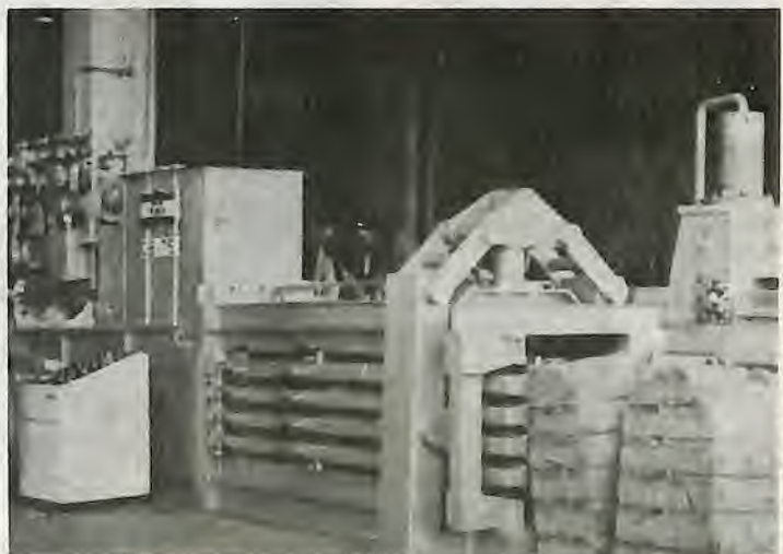
A nova prensa diminui muito o volume do bagaço da cana.
