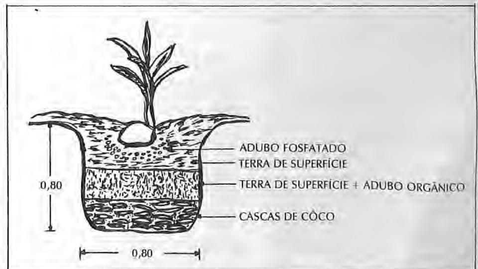
Fig. 2 — Detalhe das dimensões (m) e enchimento da cova utilizada para plantio mudas de coqueiro.
