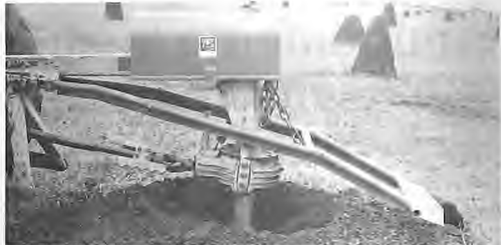
Broca destruindo o cupinzeiro abaixo do nível do solo.
