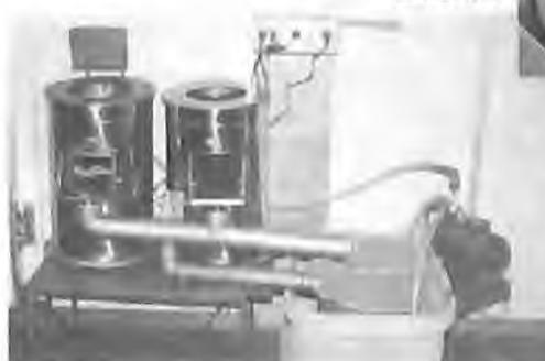
*Torneadora, equipamento nacional desenvolvido a partir de um descascador de batatas*
