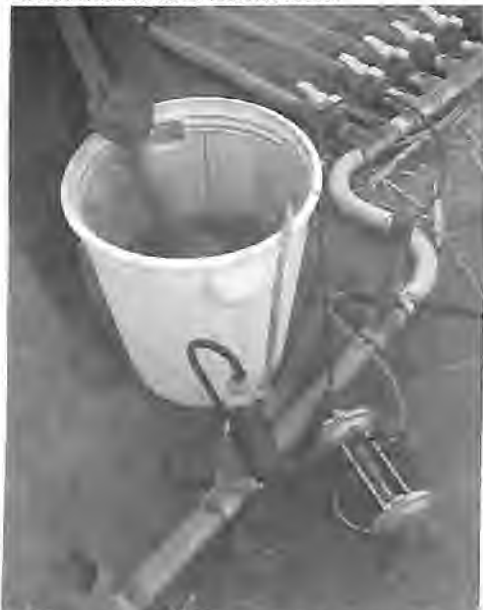
Equipamentos de injeção de fertilizantes no sistema de irrigação: bomba hidráulica injetora...
