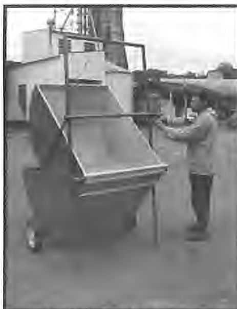
Separador hidráulico (lavador) para café
