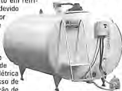
A novidade traz ainda, de acordo com a Bosio, uma tampa para fácil acesso, com uma pequena abertura para inspeção e paredes com isolamento de poliuretano expandido, o que preserva a temperatura do leite resfriado, não ultrapassando 0,8°C a cada 12 horas em temperatura média de 32°C. Completando, um agitador assegura um resfriamento uniforme do leite armazenado, além da homogeneização da gordura.
