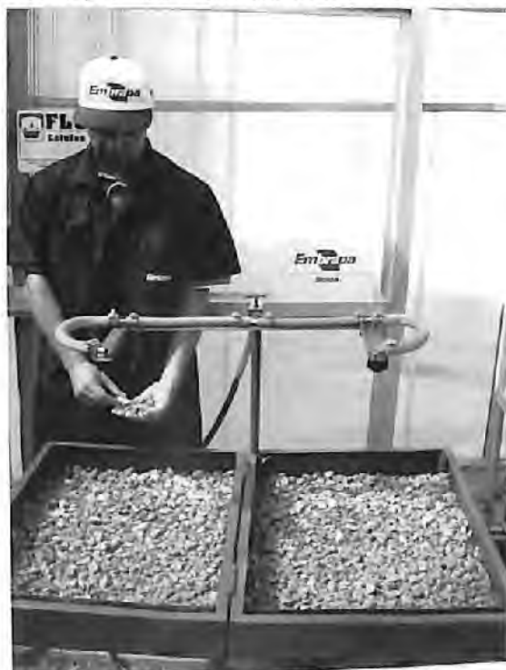
Montagem do aparelho com brita e solo nas duas caixas, coberta com uma camada de palha na caixa esquerda
