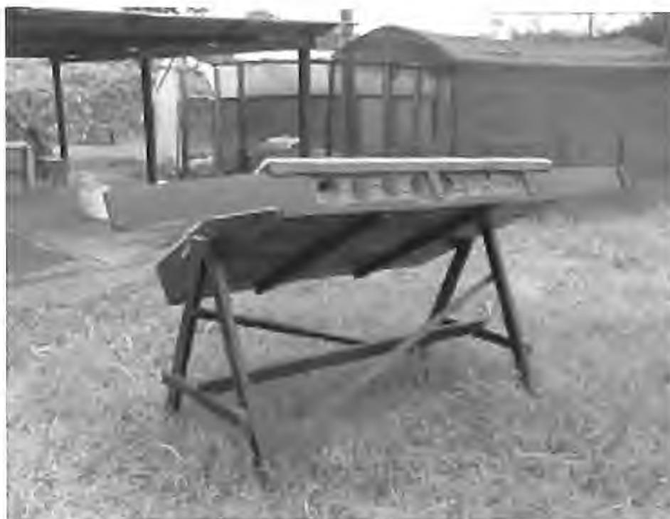
Tampas tipo "gaveta", que possibilitam uma rápida descarga
