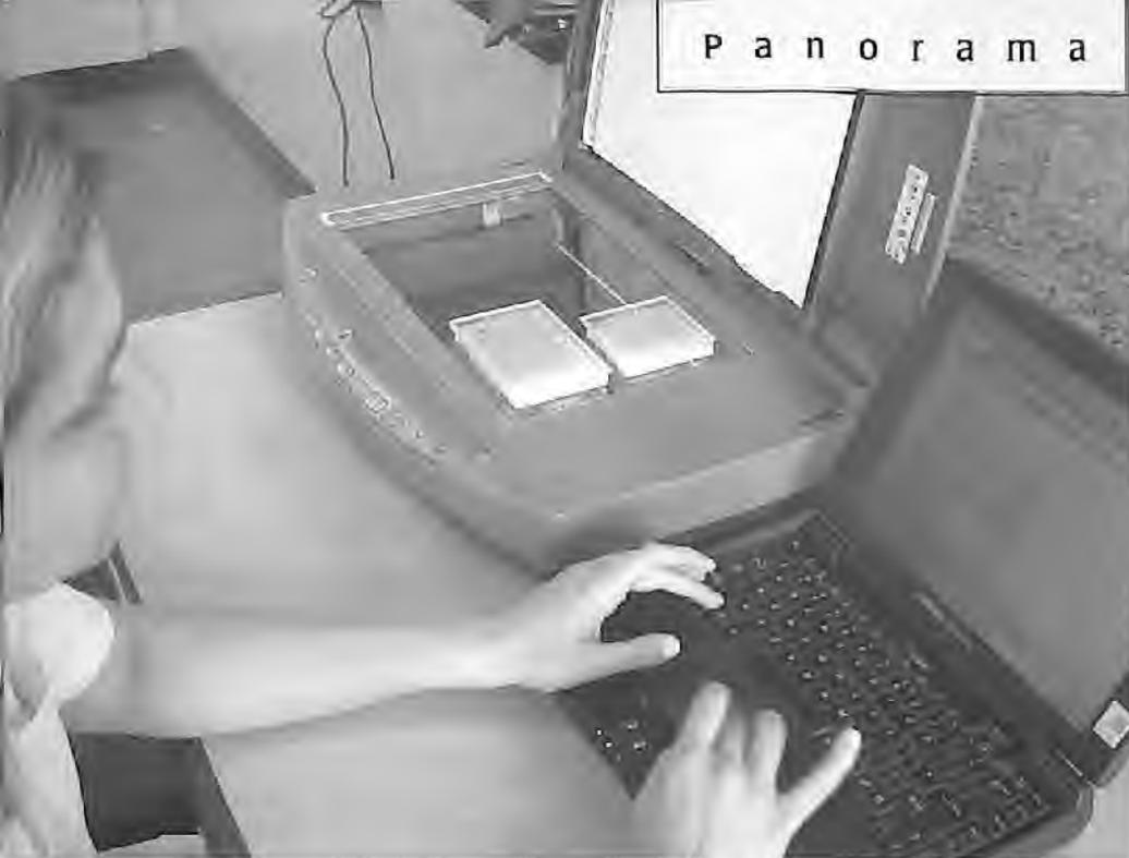
*Equipamento funciona como um scanner que interpreta a cor do teste. Se a cor for amarela, significa que o leite está isento de inibidores. Se a cor estiver roxa (lilás) significa que existem inibidores no leite.*
