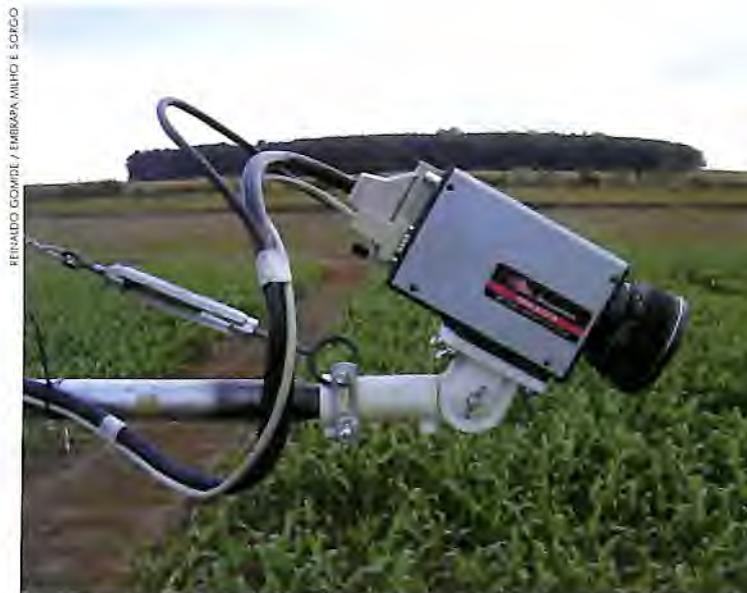
*Detalhe da câmara de alta resolução*
