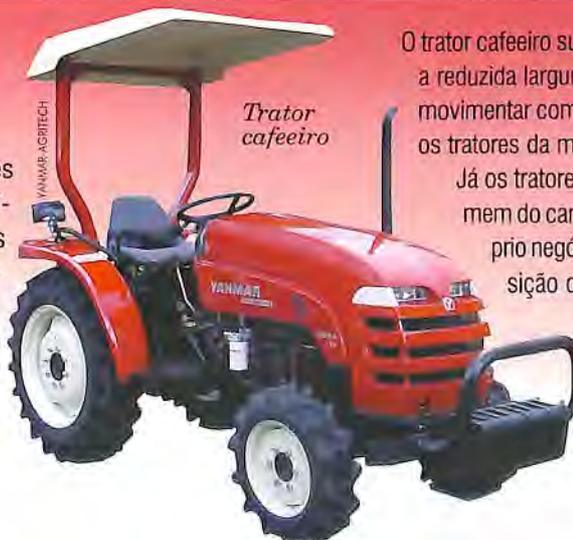
O trator cafeeiro super estreito modelo 1155 SE possui 55 cavalos e a reduzida largura de bitola externa de 1180 mm., está apta para movimentar com combustível biodiesel até B5, assim como todos os tratores da marca.
