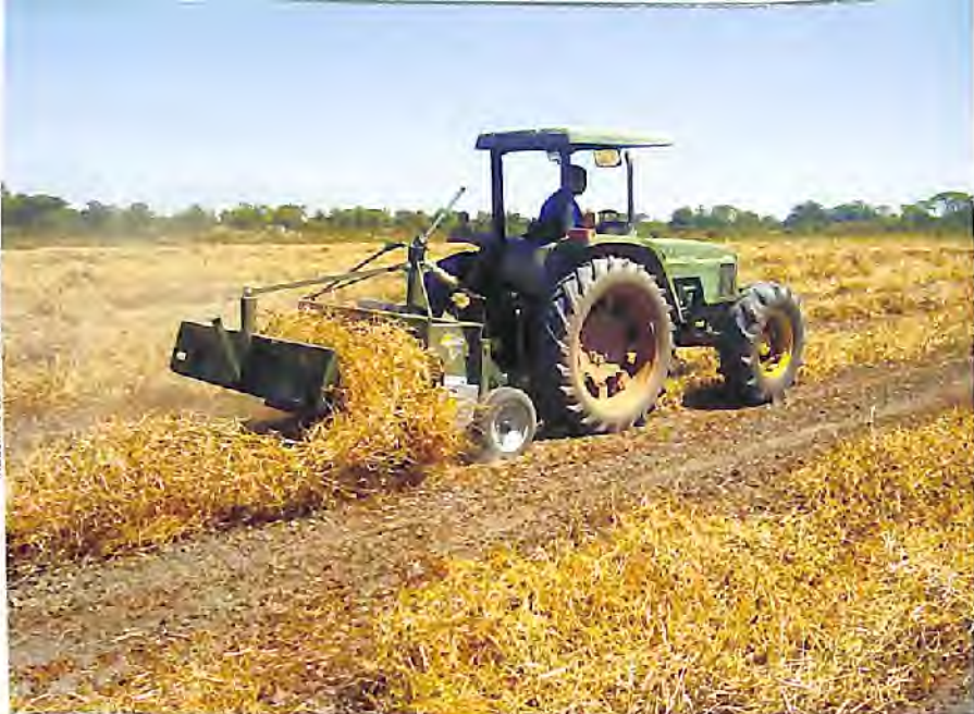
Equipamento responsável pelo invertimento (dando um tombo) na leira, sendo possível sua descarga tanto do lado direito como do esquerdo
