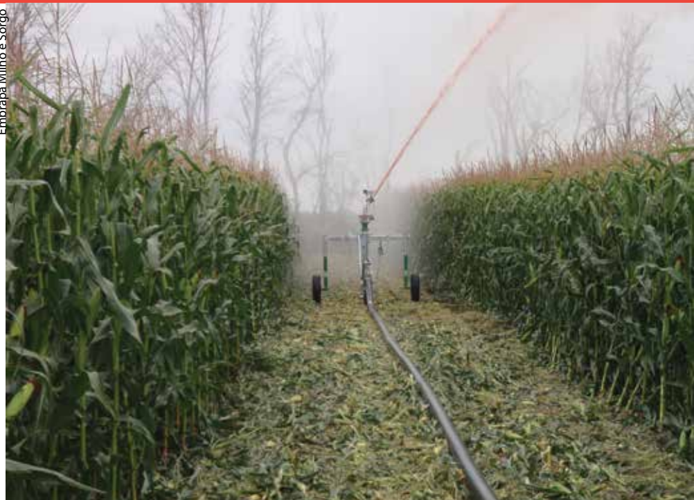
Utilização de um canhão autopropelido em plantação de milho nos Estados Unidos
