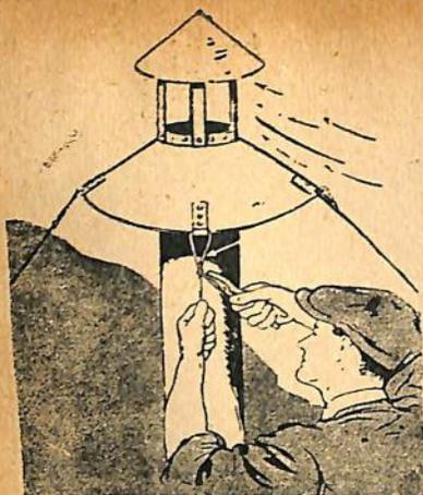
Quando uma chaminé possui pouca tiragem, pode-se aumentá-la sem se proceder ao alargamento do cano. Para isso, coloca-se junto á boca de saída da fumaça, um cone de chapa, com a inclinação devida, coniormente se vê na gravra junta, inclinação essa que serve para desviar a corrente de ar para cima, e desse modo aumentar consideravelmente a sueção da chaminé.
