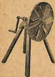
Esta maquina possui 6 facas dentadas, que reduzem as raspas a forragem, facilitando assim aos animais a mastigá-las e dígери-las.
