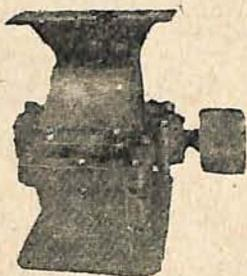
De construção sólida, com caixa toda de ferro, eixo de aço, correndo em mancais de rolamento SKF. — Serve para a trituração de milho com palha e sabugo, para a moagem de casca de cortume, ossos cozidos, pedras moles, pedras de cal, minerais, cacão, herva-mate, etc.
