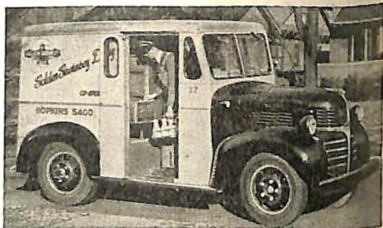
Fig. 104 — Carro de distribuição adotado nos EE. UU. Note-se a descarga pela cabine, o tamanho e conformação da porta. Carros deste tipo dispensam o ajudante.
