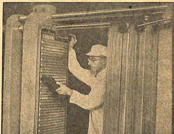
Fig. 1 — A lavagem dos aparelhos de placas com soluções adequadas para esse tipo de aparelhagem redonda em maior eficiência e melhor conservação. Para os aparelhos de placas APV, por ex., é recomendada uma solução de lavagem especial, a solução de lavagem APV.
