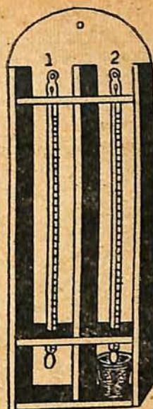
PSICROMETRO DE AUGUST. 1 — termómetro seco; 2 — termómetro úmido. A diferença entre as temperaturas dos dois, relacionada com a temperatura do termómetro seco indica o grau higrométrico do ambiente em que o psicrometro seja mantido, conforme tabela anexa.
