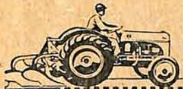
**CONTRÔLE AUTOMÁTICO DE ONDULAÇÃO** — Em terrenos de condições uniformes, os implementos são mantidos na profundidade escolhida, mesmo que a superfície do solo seja irregular.
