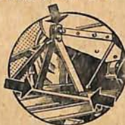
Arado de discos Dearborn, montado como parte integrante do trator Ford — e não de arrasto. Com 2 discos, faz o serviço de 3.
