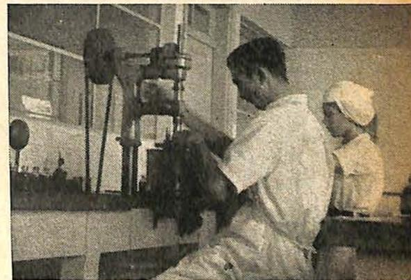
A vacina é acondicionada nos vidros por meio deste aparelho, que permite conservá-la num absoluto estado de pureza.
