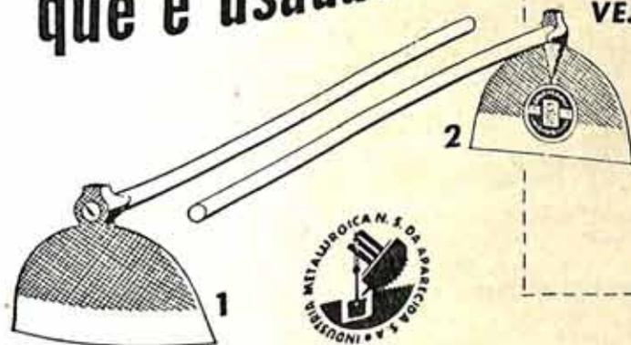
**VEJA COMO:** O fio da enxada é formado por duas chapas de aço superpostas. A do lado da frente - n.º 1 - é de aço extra-doce; a do lado de traz - n.º 2 - é de aço extra-duro. Com o uso, desgasta-se em primeiro lugar o lado da frente - n.º 1 - deixando sempre afiada a lâmina de aço extra-duro - n.º 2.
