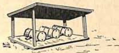
Abrigo para armazenagem de tambores de combustíveis
