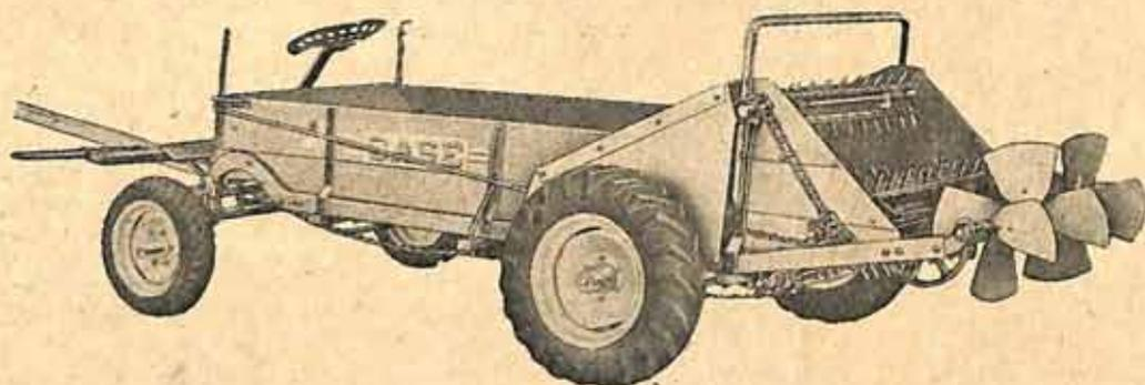
Máquina esparramadeira de adubo orgânico de quatro rodas pneumáticas, para tração animal ou motorizada.
