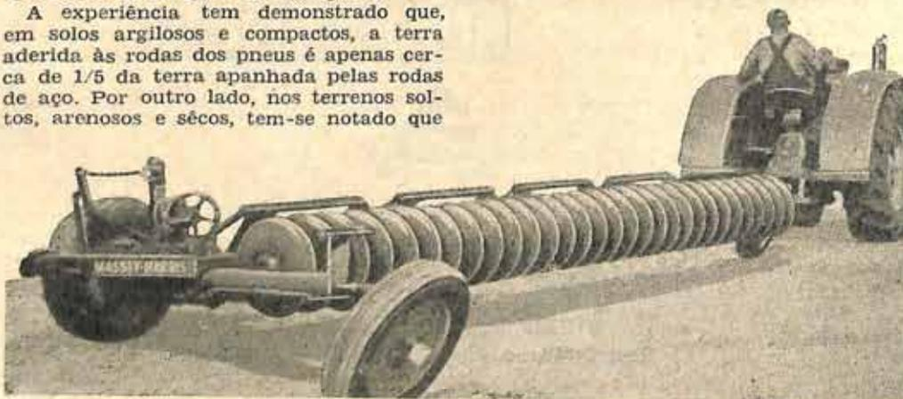
As máquinas pesadas são mais facilmente manobráveis e de transporte mais rápido quando equipadas com rodas pneumáticas.
