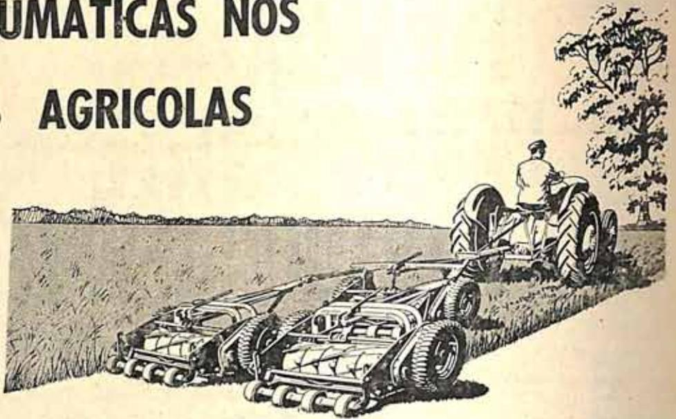
As rodas pneumáticas têm larga aplicação nos implementos atrelados, pois facilitam sua movimentação, sem trepidações excessivas.
