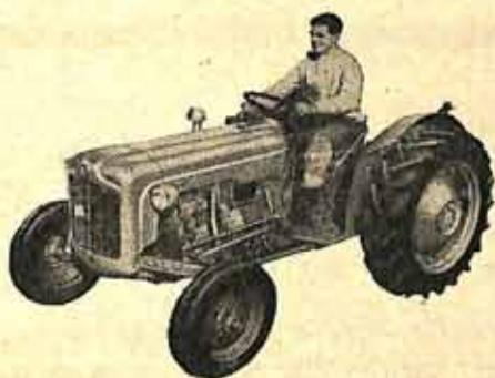
O DEXTA é altamente eficiente e o seu compacto motor de 3 cilindros diesel, com quatro mancais de centro desenvolve 36 b.h.p. Construído de maneira que toda a potência seja aproveitada pela tração, o DEXTA pode utilizar enorme variedade de implementos. A sua transmissão com seis marchas para a frente e duas à ré, proporciona uma ampla gama de velocidade, que vai de 3 km por hora até 27 km por hora, assegurando o trabalho nas velocidades
