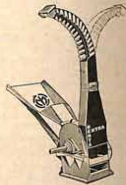
MENTA EXTRA 7 a 12 HP — 4.500 a 8.000 kg/hora. — R.P.M. 2.000. Quatro faces de 170 mm.
