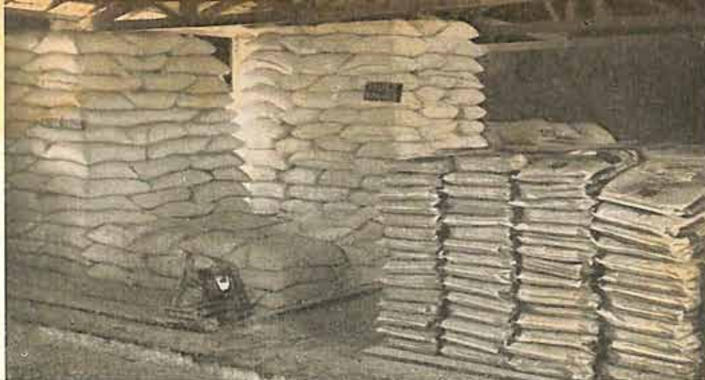
Detalhe da fábrica de rações, notando-se a boa distribuição da matéria prima, empilhada por categoria, em estrados de madeira.
