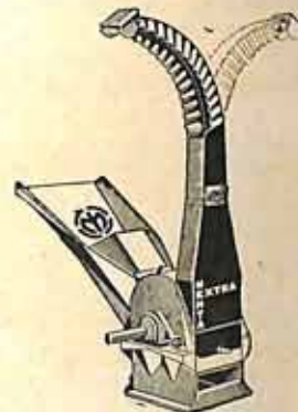
MENTA EXTRA. 7 a 12 HP — 4.500 a 8.000 kg/hora. — R.P.M. 2.000. Quatro faces de 170 mm.
